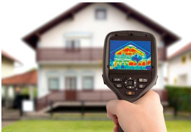
wird bei einer Gebäudethermografie die Wärmedämmung von Häusern überprüft. Mit diesem Verfahren können „undichte Stellen“ im Haus sichtbar gemacht und in Folge gezielt Maßnahmen gesetzt werden, um das unerwünschte Entweichen von Wärme – bei Fenstern, Türen oder über die Decke – zu verhindern. Damit können Energie und anfallende Energiekosten gespart werden.
