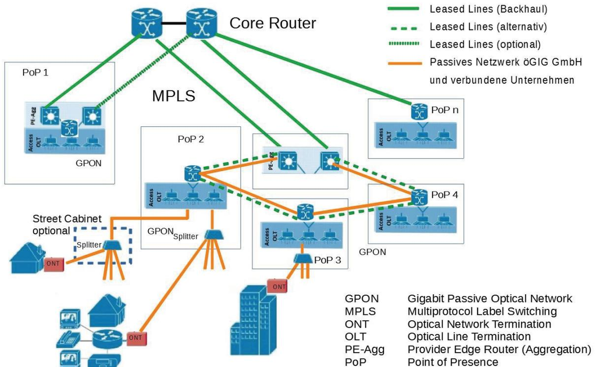
Erfordert die Netzwerktopologie Verbindungen zwischen PoPs, werden diese grundsätzlich auf Basis des Netzes der BE Technology GmbH realisiert. Wenn diese erst in einer späteren Ausbauphase verfügbar sind, können diese Verbindungen auch temporär als Leased Line ausgeführt sein.
